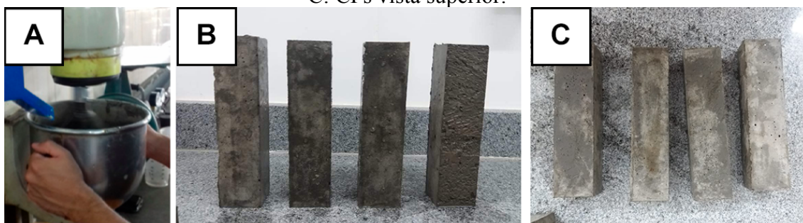
Figura 7. Confeção de corpo de provas (CPs). A: argamassadeira. B: CPs vista frontal. C: CPs vista superior.
