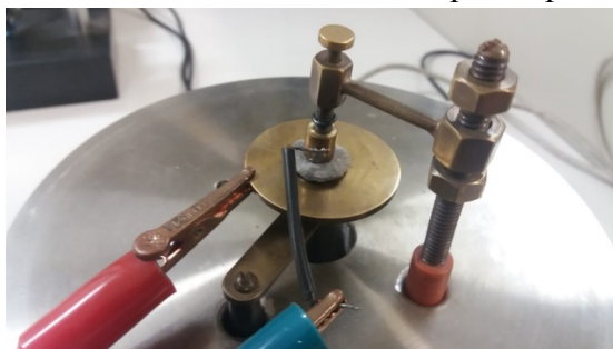
Figura 9. Leitura de condutividade elétrica das pastas pelo método 2 pontos
