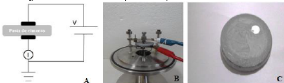
Figura 1. Método das duas pontas em pastas de cimento Portland.
