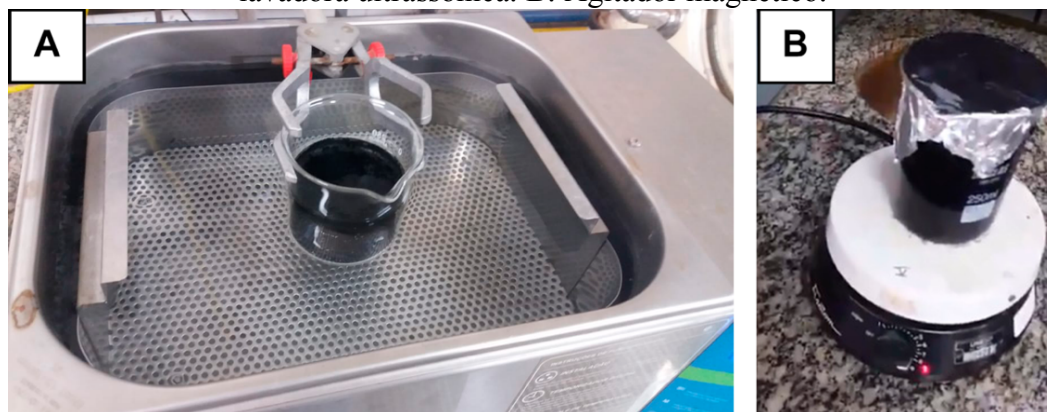
Figura 6. Processo de funcionalização com ácido oxálico. A: Solução em banho na lavadora ultrassônica. B: Agitador magnético.
